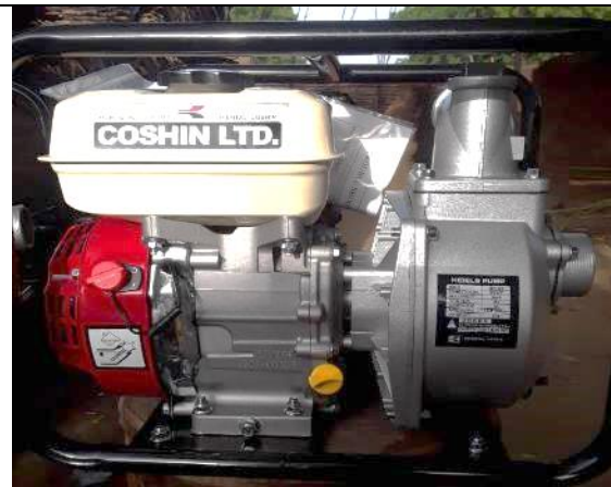
Marque : COSHIN, Puissance 2.5CV, Prix 80.000 F et 77.000 F, Moteur à essence, 600L/Mn Lieu de vente : Sabon Guida / Tounfafi / Badaguichiri
