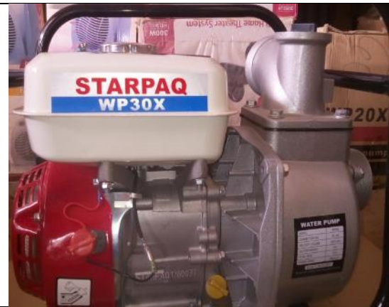
Marque : STARPAQ, Puissance 3CV ; moteur à essence ; 1000L/Mn, Prix 75.000 F Lieu de vente : Konni
