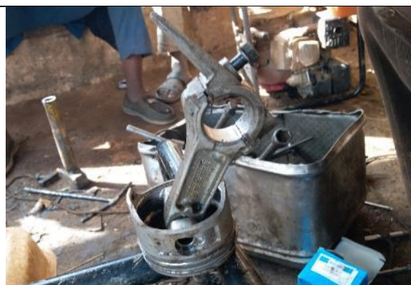
Les segments, pistons et bielles sont les pièces les plus changées lors des réparations.
