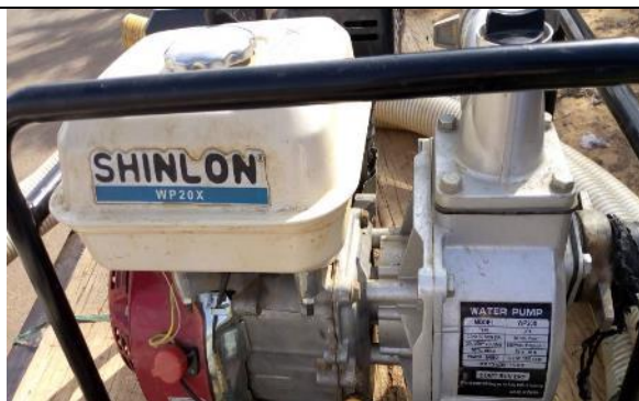
Marque : SHINLON, Puissance 2 CV et 3 CV ; moteur à essence ; 34m 3 /h, Prix : 55.000 F (2cv) 75.000 F (3cv) Lieu de vente : Tabalak
