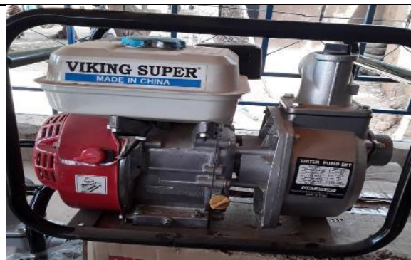
Marque : VIKING SUPER, Puissance : 3 CV ; 36m 3 /h ; Moteur à essence, Prix : 55.000 F Lieu de vente : Sabon Guida
