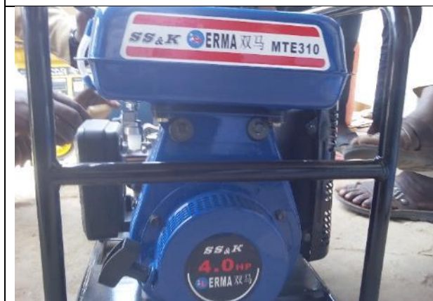
Marque : ERMA MTE 310, Puissance 3CV ; Moteur à essence ; 1000L/Mn, Prix 123.000 F Lieu de vente : Konni
